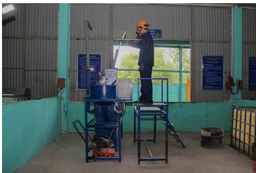
Hệ thống xử lý bóng đèn huỳnh quang – 4kg/h
