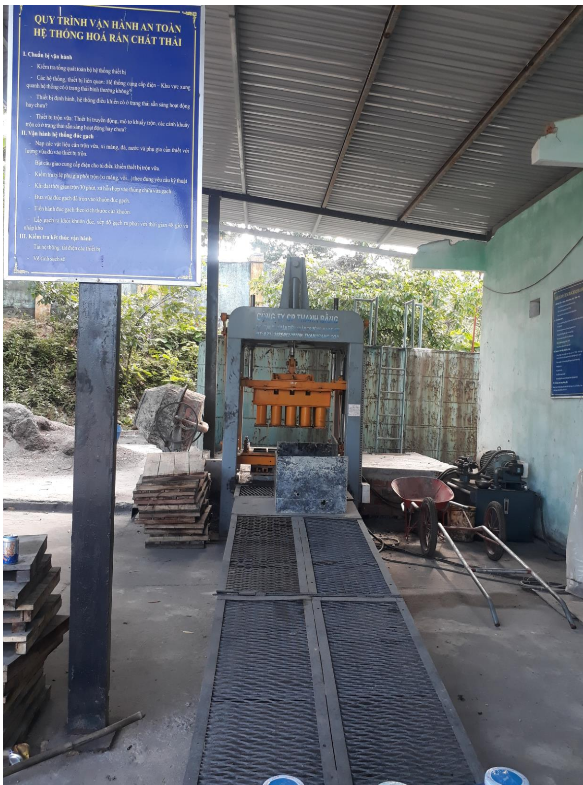
Hệ thống hóa rắn – 1.200kg/h
