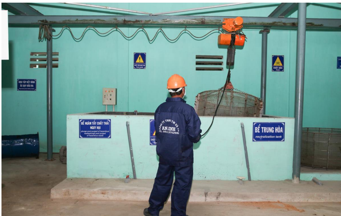
Hệ thống tẩy rửa nhựa, kim loại dính dầu, hóa chất – 500kg/h
